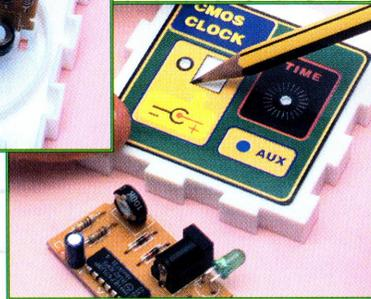
Antes de colar a etiqueta sobre a tampa do equipamento devemos marcar os lugares onde vamos realizar os orifícios para inserir o diodo, o conector de alimentação, o LED e o potenciômetro. Quando já estiverem marcados, realizaremos os orifícios com muito cuidado. Depois limaremos até conseguir a forma retangular desejada.
