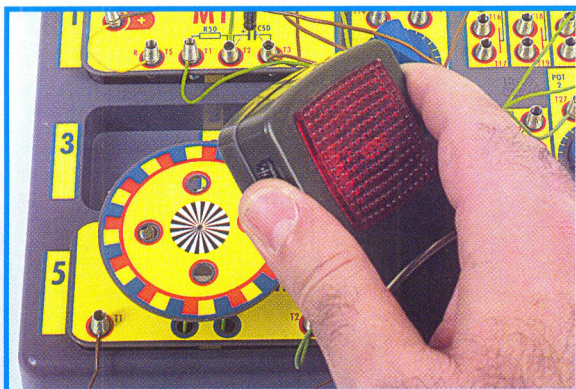
A luz incide no fototransistor quando passa por um orifício do disco diante dele.
