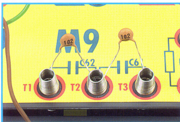
Com dois capacitores de 1 nF, e com o potenciômetro POT1 na posição R60, obtém-se uma frequência de saída que pode ajustar-se entre 670 Hz e 2,4 kHz.
