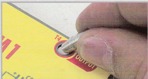
**3** Depois que se colocou a etiqueta, procede-se à instalação das molas de contato nos lugares que marca a etiqueta. Introduzimo-las pelo painel frontal e as puxamos levemente pelo interior, girando-as para facilitar sua colocação, até que fiquem bem centradas no painel. Deverá se ter cuidado de prender o painel pelas beiras para não estragar a etiqueta.
