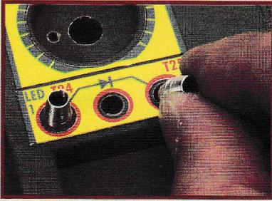
**1** Para instalar uma mola de conexão, introduzimo-la no orifício correspondente e a empurramos até que apareça pelo interior do painel. Puxamos a mola, girando em sentido contrário ao dos ponteiros do relógio, até que a zona central da mola, que é mais estreita, fique encaixada no orifício do painel. Não devemos esticar a mola, pois pode deformar-se de maneira definitiva.
