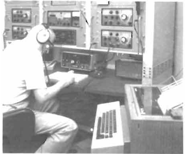
Nello shack di i3EMC i problemi della e.m.c. sono risolti: in primo piano una telescrivente a logiche elettroniche che molti considerano impossibile da usare vicino ad apparecchiature a.f.
