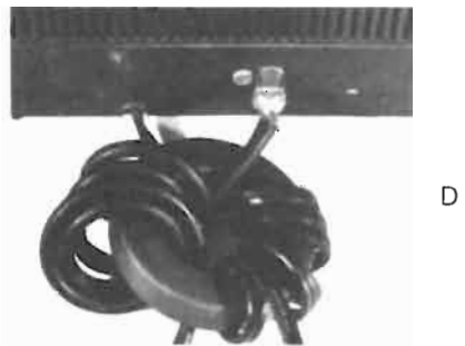
Fig 6 - Nei casi più difficili è necessario anche filtrare per la r.f. i conduttori che entrano ed escono dalle cassette metalliche. La capacità massima da usare per circuiti B.F. disturbati da r.f. è 47 nF; però se si tratta di circuiti con frequenza più elevata, la capacità discenderà a 330 pF. Tale capacità infatti, deve essere una buona fuga per la r.f. ma non deve disturbare il regolare funzionamento del circuito che viene filtrato. Se la capacità da sola è insufficiente e non risolve il problema, si costituisce un filtro ad L «passa basso», con induttanza inserita e capacità in parallelo. Se le frequenze distur-
