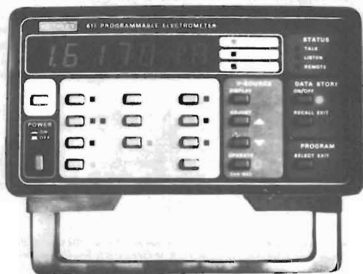
Il 617 Keithley ad alta sensibilità e tabella campi/funzioni di misura.
