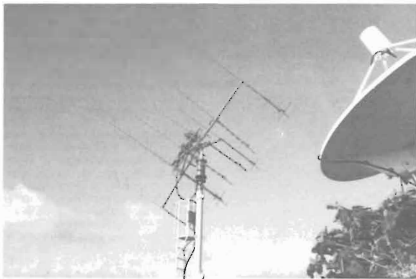
Fig. 1 - Le antenne di TR8BL presso Libreville in Gabon. Per la gamma 1.2 GHz (Modo L up) paraboloide di 2 metri; guadagno 26 dB per la gamma 435 MHz (modo L-down e modo B-up) 4 yagi 14 x 2 elem. Per la gamma 145 MHz (Modo B - down) 4 yagi 9 x 2 elem. In ricezione: preamplificatori «a palo» Dressler. Collegamento allo shack: 12 metri di cavo concentrico da mezzo pollice conosciuto in gergo come: «hard-line».
