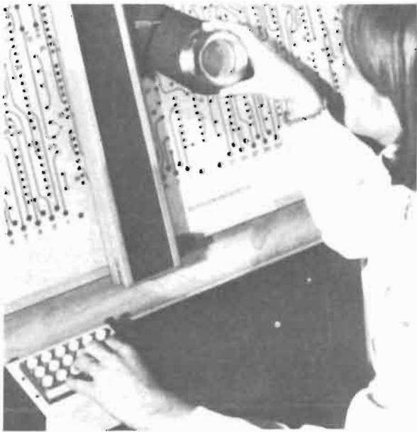
Fig. 12/36 - Rilevamento di dati di posizionamento per un progetto di circuito stampato mediante apparecchio lettore di coordinate).
