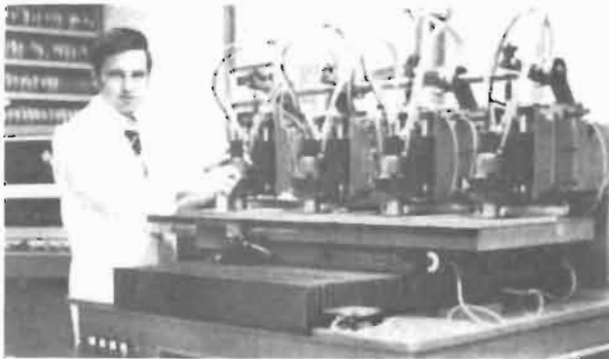
Fig. 12/37 - macchina perforatrice a più punte controllata numericamente per circuiti stampati).
