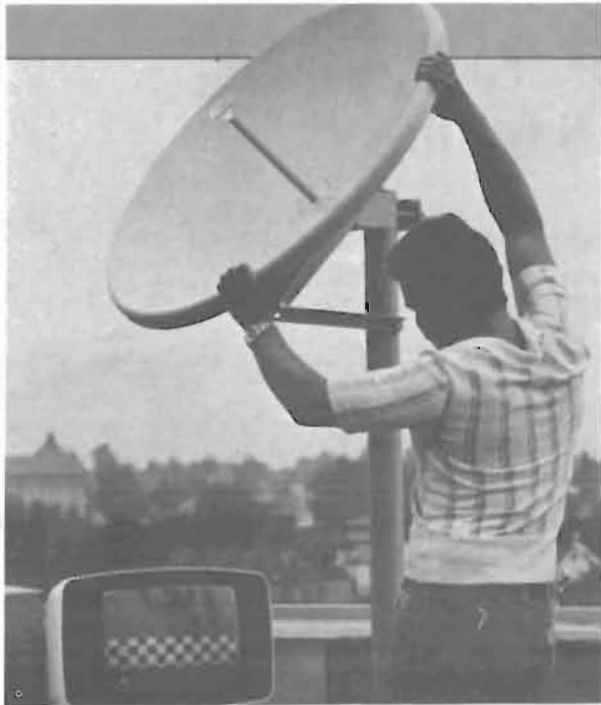
Fig. 1 - Impiegando delle sorgenti fittizie a 12 GHz, che simulano un segnale in arrivo dal satellite alla stessa potenza di quello che si stima arriverà in Terra fra due anni circa ( -149 dBW); in Germania si mettono a punto antenne con paraboloide da 90 cm di diametro e convertitori SHF per la DSB.
