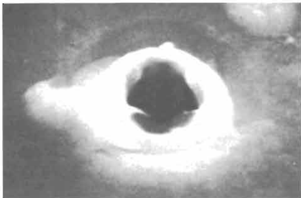
Fig. 1 - Il cratere in uno straterello di ossido isolante (gate di MOSFET) prodotto da una scarica elettrostatica. (foto al microscopio elettronico: 8000 ingrandimenti eseguita presso il Jet Propulsion Lab. USA).
