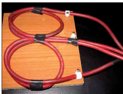
Fig. 3 - Esempi di bobine per riscaldare pentole, lamiere e superfici estese.
