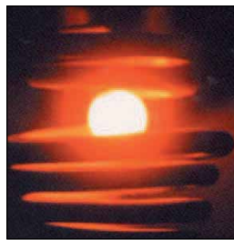
Fig. 1 - Fusione a induzione elettromagnetica a microgravità.
