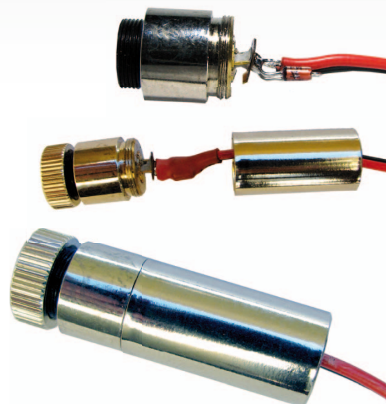
In sequenza, il diodo a cui abbiamo saldato i fili, quindi la guaina termoretraibile e infine abbiamo chiuso l'involucro.
