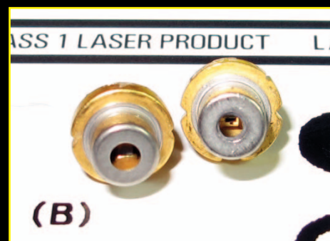
Questo è il tipo più comune di contenitore di diodo laser, con un diametro di 5,6 mm e una finestrina trasparente da cui esce il raggio.
