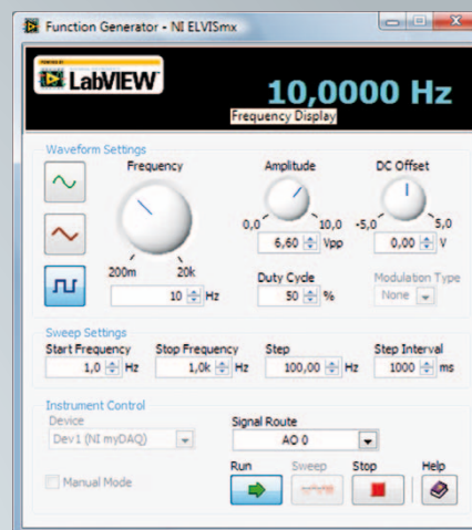
Fig. 8 - Ambiente di lavoro iMPACT (a sinistra) e pannello di controllo del Function Generator del myDAQ (qui sopra).
