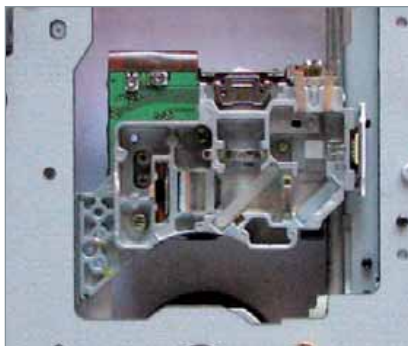
L'ottica del pickup visibile nel dettaglio in E ed F nella colonna qui accanto.
