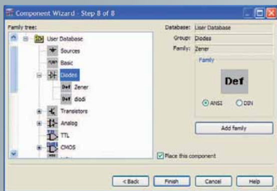
Fig. 18 - L'inserimento del nuovo componente nella libreria di Multisim.al footprint.
