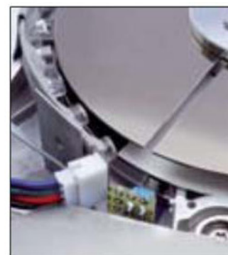
Assemblaggio della striscia di LED e del fotointerruttore, che abbiamo estratto dal suo contenitore, montando LED e fotodiodo su una millefori, a ridosso del disco più in basso.
