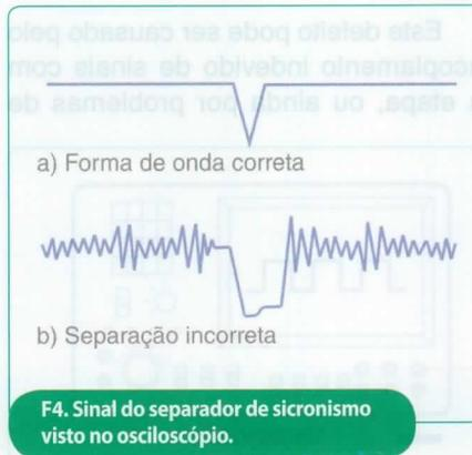
F4. Sinal do separador de sincronismo visto no osciloscópio.
