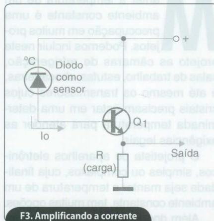
F3. Amplificando a corrente do sensor.
