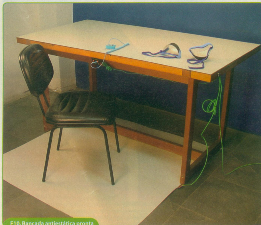
F10. Bancada antiestática pronta com piso aplicado sob ela
