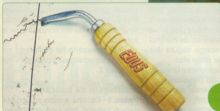
F3. Mesa utilizada e corte do Formipiso com um riscador para fórmica, facilmente encontrado no mercado
