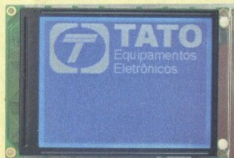
Novo display serial gráfico. Resolução de 320x240
