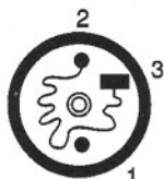
Fig.3 Vista interna sem a lâmina bimetálica
