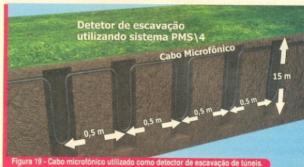
Figura 19 - Cabo microfônico utilizado como detector de escavação de túneis.
