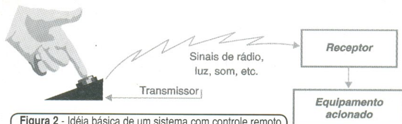
Figura 2 - Idéia básica de um sistema com controle remoto.
