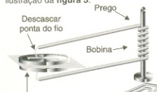
Figura 3 - Um pequeno eletroímã pode detectar a energia gerada por uma pilha experimental.
