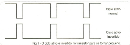
Fig. 1 - O ciclo ativo é invertido no transistor para se tornar pequeno.
