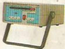
Mede transistores, FETs, TRIACs, SCRs, identifica elementos e polarização dos componentes no circuito. Mede diodos (aberto ou em curto) no circuito.
