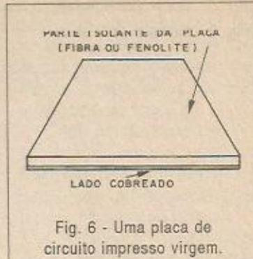
Fig. 6 - Uma placa de circuito impresso virgem.
