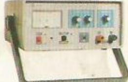
Fonte variável de 0 a 30V, Corrente máxima de saída 2 A, Proteção de curto, permite-se fazer leituras de tensão e corrente AS tensão: grosso fino AS corrente.
