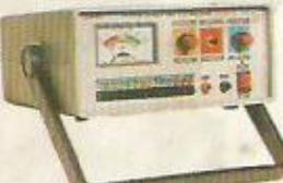
Mede FLYBACK/YOKE estático quando se tem acesso ao enrolamento. Mede FLYBACK encapsulado através de uma porta MAT. Mede capacitores eletrolíticos no circuito e VPP.
