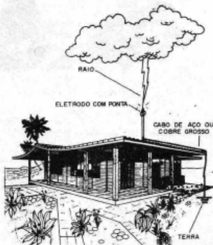
Este percurso é então dado por um cabo que termina numa boa terra que pode ser formada por placas ou barras de metal enterradas. Para que a descarga ocorra com mais facilidade alguns artificios podem ser usados como por exemplo o uso de eletrodos com pontas, já que as descargas tendem sempre a ocorrer a partir das pontas dos objetos, figura 3.
