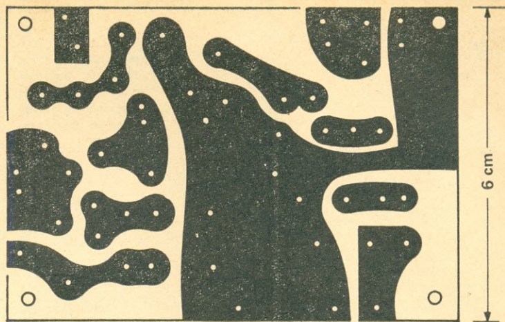
FIG. 2 — O minitransmissor foi montado sobre uma plaqueta de circuito impresso. Em a) temos a face cobreada da plaqueta e em b) a disposição dos componentes.
