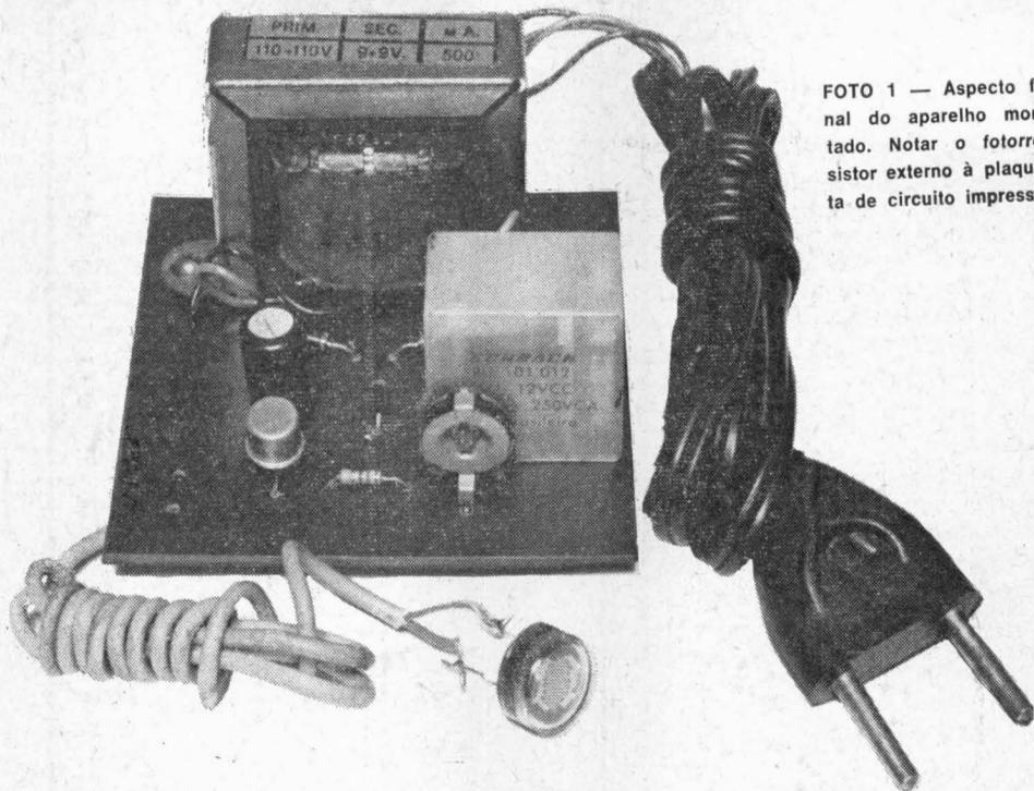
FOTO 1 — Aspecto final do aparelho montado. Notar o fotorresistor externo à placa de circuito impresso.
