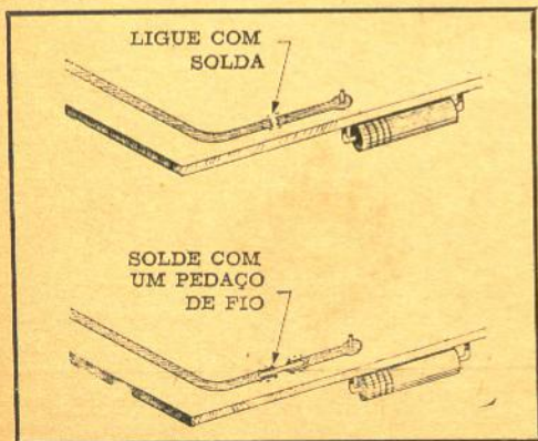
FIG. 3 — Dois métodos para reparar rupturas das lâminas de cobre de um circuito impresso.
