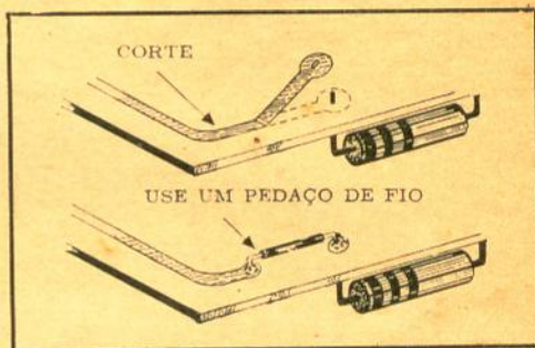
FIG. 4 — Modo de reparar os pedaços descolados da lâmina de cobre de um circuito impresso.
