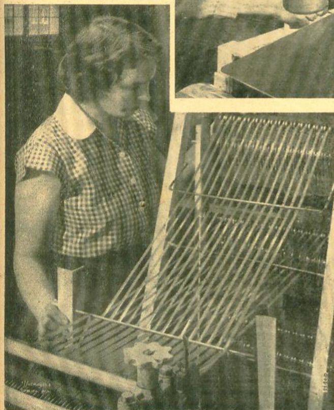
Cortando fitas de 1/4" de rolos grandes já revestidos com a camada magnética.
