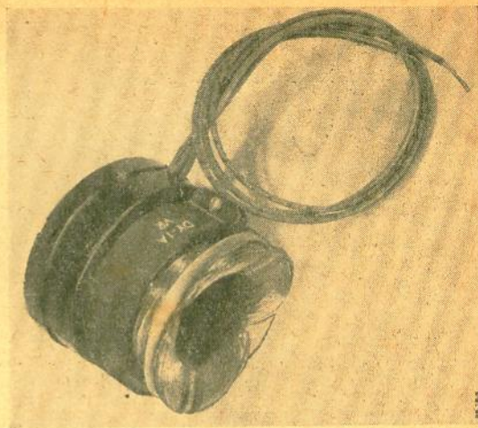
FIG. 5 — A fotografia mostra uma coleira de deflexão típica de um moderno receptor de TV.
