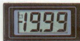
Voltímetro de painel que, com uma resistência em paralelo de baixo valor, se converte num amperímetro.
