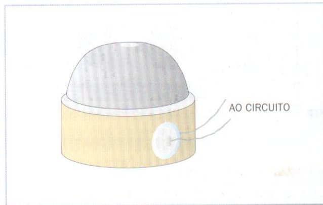
Instalação do sensor piezoelétrico dentro do timbre complementar.
