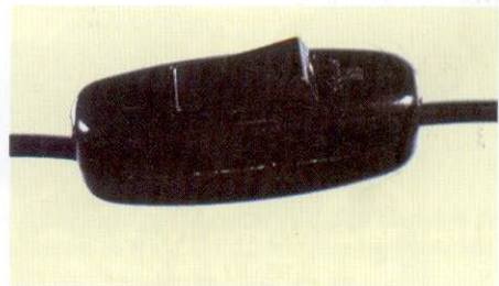
O equivalente mecânico do nosso circuito é um interruptor que muda de estado com cada pulsação.
