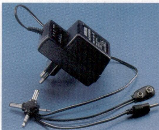
A alimentação pode ser tomada de uma fonte de alimentação normal estabilizada 12 V, que pode ser adquirida em qualquer loja de eletrônica.
