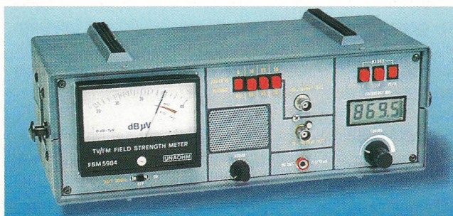
Medidores de campo de precisão; observe a entrada com tomada coaxial para altas frequências.
