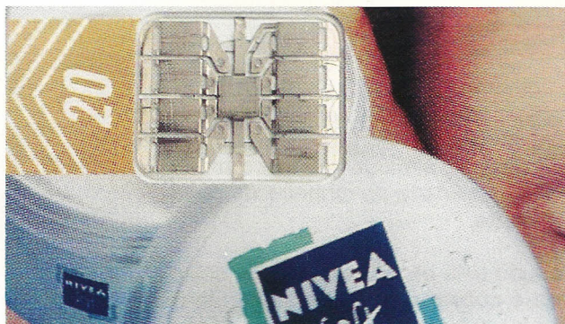
Os circuitos integrados utilizados nos "cartões inteligentes" devem resistir a fortes descargas elétricas.
