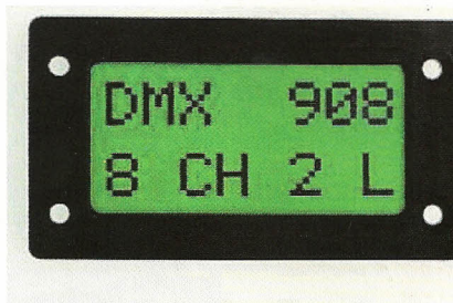
Monitor LCD da matriz de pontos com controlador e gerador de caracteres incorporados.
