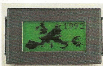
LCD gráfico de 70 x 23 pixels, com RAM interna: cada pixel pode ser controlado individualmente.
