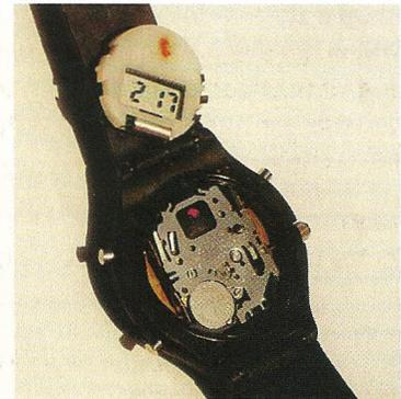
*Um relógio tem, pelo menos, três componentes fundamentais: visor, circuito integrado e pilha.*
