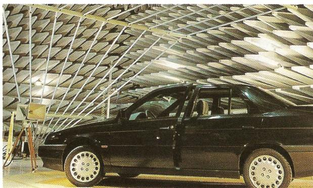
*Câmara para o controle das emissões eletromagnéticas e da sensibilidade da eletrônica de bordo com as interferências.*
