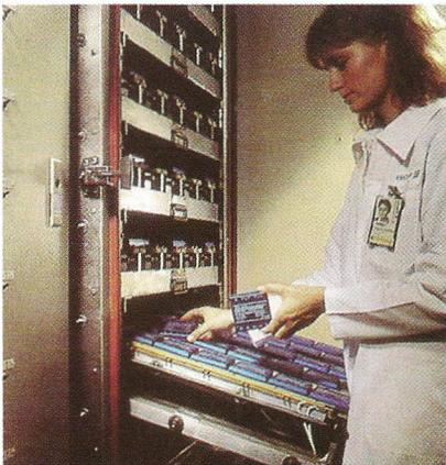
*Câmara climática com temperatura controlada para o teste e o burn-in dos dispositivos terminados.*
