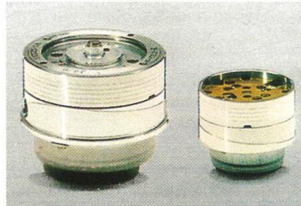
*A cabeça de um aparelho de vídeo está encerrada em uma blindagem metálica para evitar que capte interferências.*
