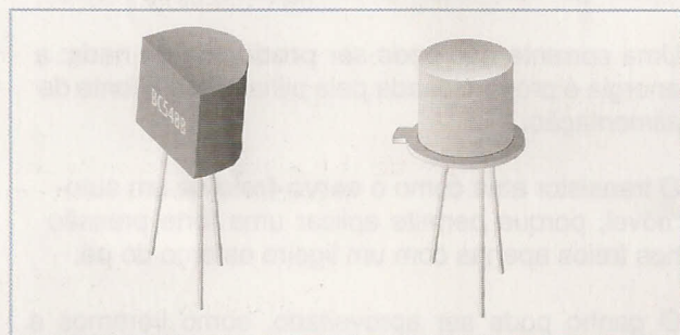
Encapsulamentos habituais dos transistores de baixa potência.
