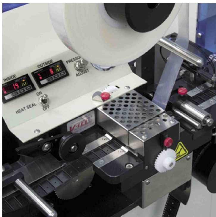
Fotografia 4. Automatyczna pakowarka układów w taśmy firmy V-TEK we współpracy z programatorem
