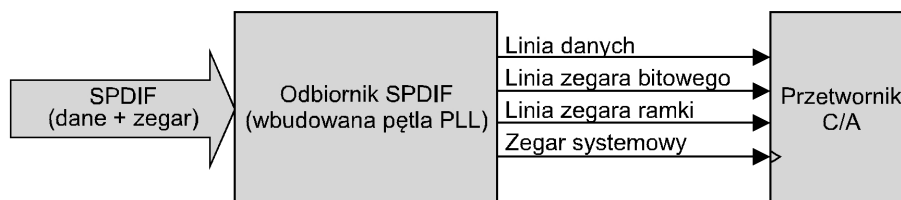
Rysunek 7. Schemat blokowy rozwiązania problemu synchronizacji w oparciu o PLL
