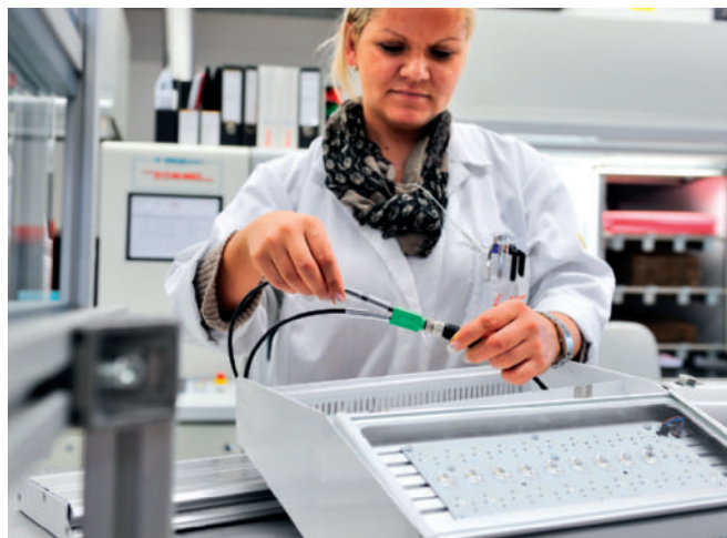
Bild 2: Bei der Produktion der LED-Straßenleuchten von Clever-Lights dienen unter anderem M12-Steckverbinder von Phoenix Contact zur Verkabelung.
