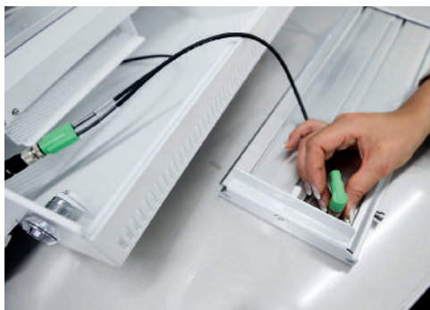
Bild 3: Der M12-Y-Verteiler (links) mit seiner Schnellanschlusstechnik Speedcon verbindet die beiden LED-Leiterplatten zuverlässig – angespritzte Tüllengehäuse sorgen für langlebige Kontaktierung unter rauen Umweltbedingungen.
