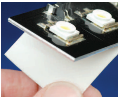
Wärmeleitfähige, isolierte Metalls substrat-Boards speziell für LED-Anwendungen
