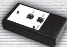
Tester wzmacniaczy operacyjnych 741 i tajmerów 555 str. 37
