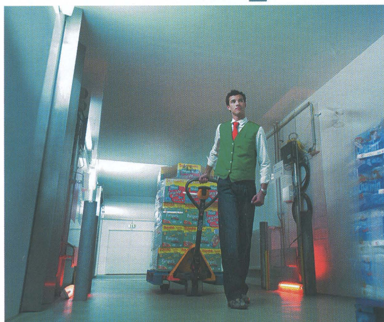
Um empregado transporta uma paleta de embalagens através de uma antena para leitura de etiquetas RFID. A antena, colocada de ambos os lados (visível no lado direito da foto) permite a leitura de todas as etiquetas RFID das embalagens. (Foto: Philips)
