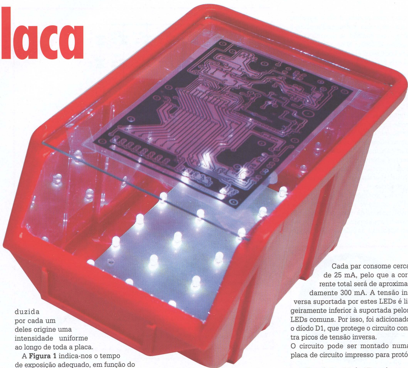
Figura 2. Disposição dos LEDs na placa com formato Eurocard.
