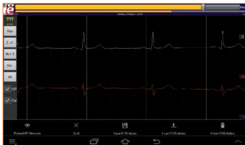
Figura 15. Funciones del menú: conexión BT, salir, salvar releer los ECGs, borrar la memoria ECG.
