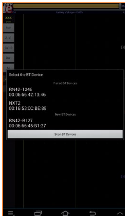
Figura 16. La actividad BtListActivity muestra la lista de los periféricos emparejados y busca otros dispositivos en el rango.
