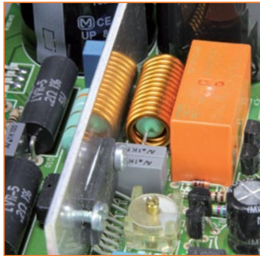
Figura 3. Toma detalle de la bobina de salida L1 con la resistencia de potencia R12 dentro.
