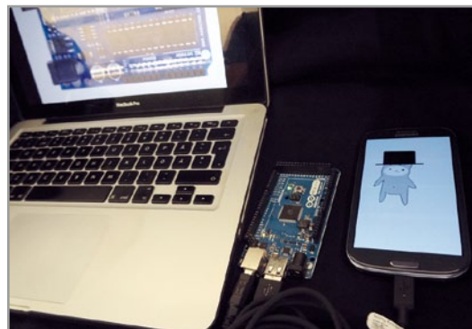
Figura 2. ADK Mega Arduino conectado a un PC y a un teléfono.
