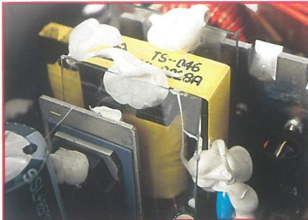
**Figura 11.** Un condensador de clase Y aprobado.
