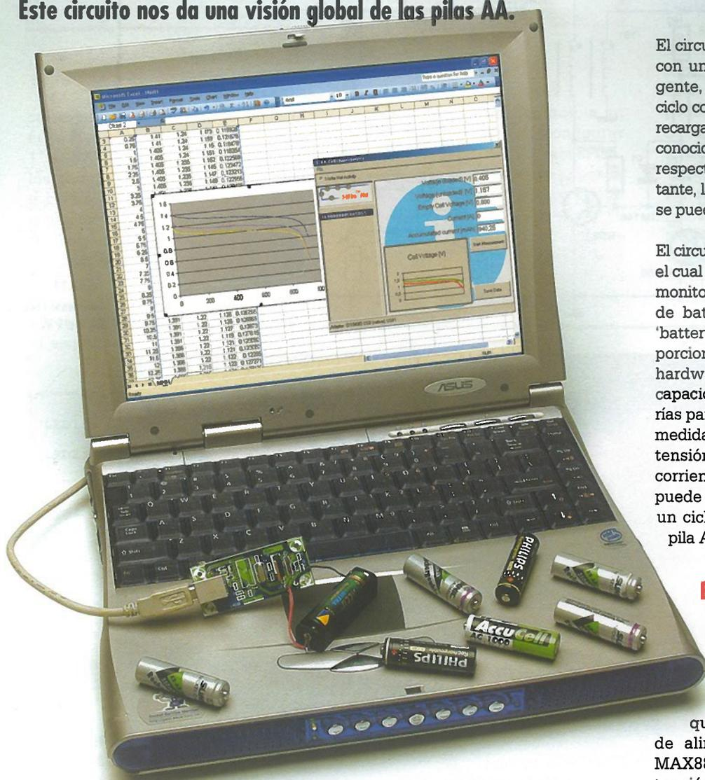
El circuito propuesto, en combinación con un PC y algo de software inteligente, puede medir con precisión un ciclo completo de descarga de una pila recargable AA de 1,2 V o AAA, también conocida como de 'linterna' y 'bolígrafo' respectivamente. Desde la curva resultante, la capacidad y resistencia interna se pueden determinar de forma simple.
