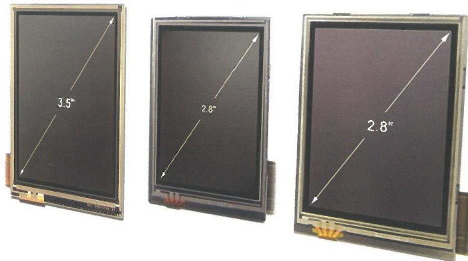
*Paneles TFT-LCD LTPS y AMOLED para teléfonos móviles, PDA y dispositivos handheld digitales.*
