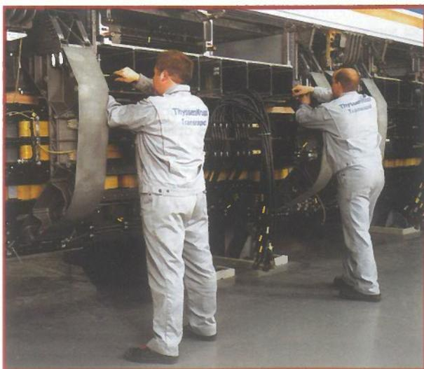
**Figura 5.** Bajo la cubierta del sistema de propulsión y guiado del tren Transrapid. (Fuente: Siemens AG).
