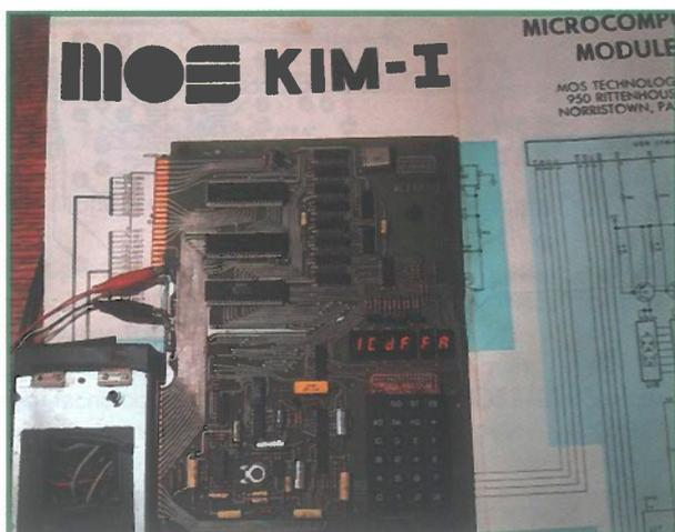
**Figura 1.** El ordenador KIM-1, desarrollado por MOS Technology. La entrada era a través de un teclado hexadecimal, para la salida un display de dígitos a LED hace la presentación.
