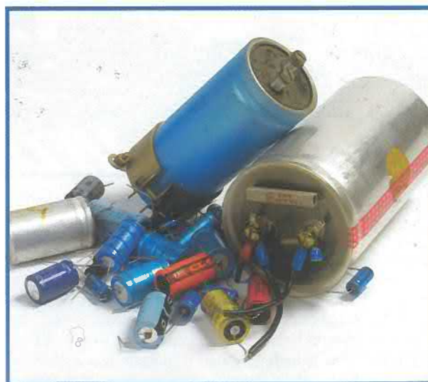
Figura 3. Los condensadores electrolíticos tienen un problema en su recogida de basura. Los modelos más viejos pueden contener sustancias peligrosas, al igual que sucede con las placas de circuito impreso.
