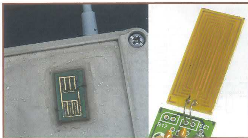
Figura 4. El sensor de lluvia se puede hacer desde la placa de un viejo teclado (izquierda), o grabarlo nosotros mismos (derecha). La corrosión del sensor del autor se produjo por la tensión continua que se aplicó en la primera versión de prototipo.
