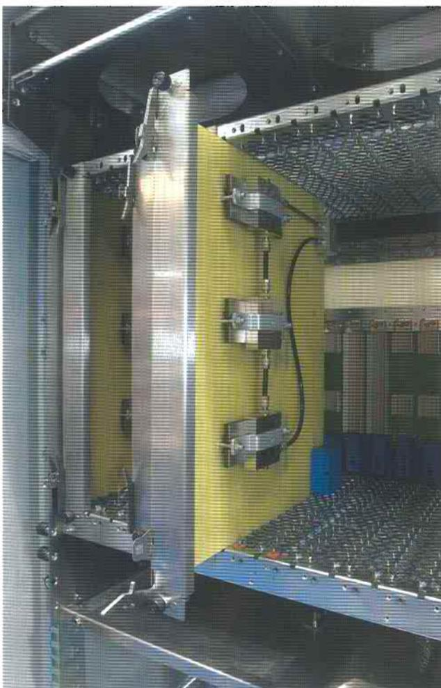
*Rittal ATCA\_CPU: Rittal ofrece ahora con su nueva solución de infraestructura para ATCA-Shelfs una refrigeración de CPU's basada en líquidos de gran potencia, capaz de disipar al 100% la potencia de pérdida de hotspot, hasta 250 W por cm<sup>2</sup>.*
