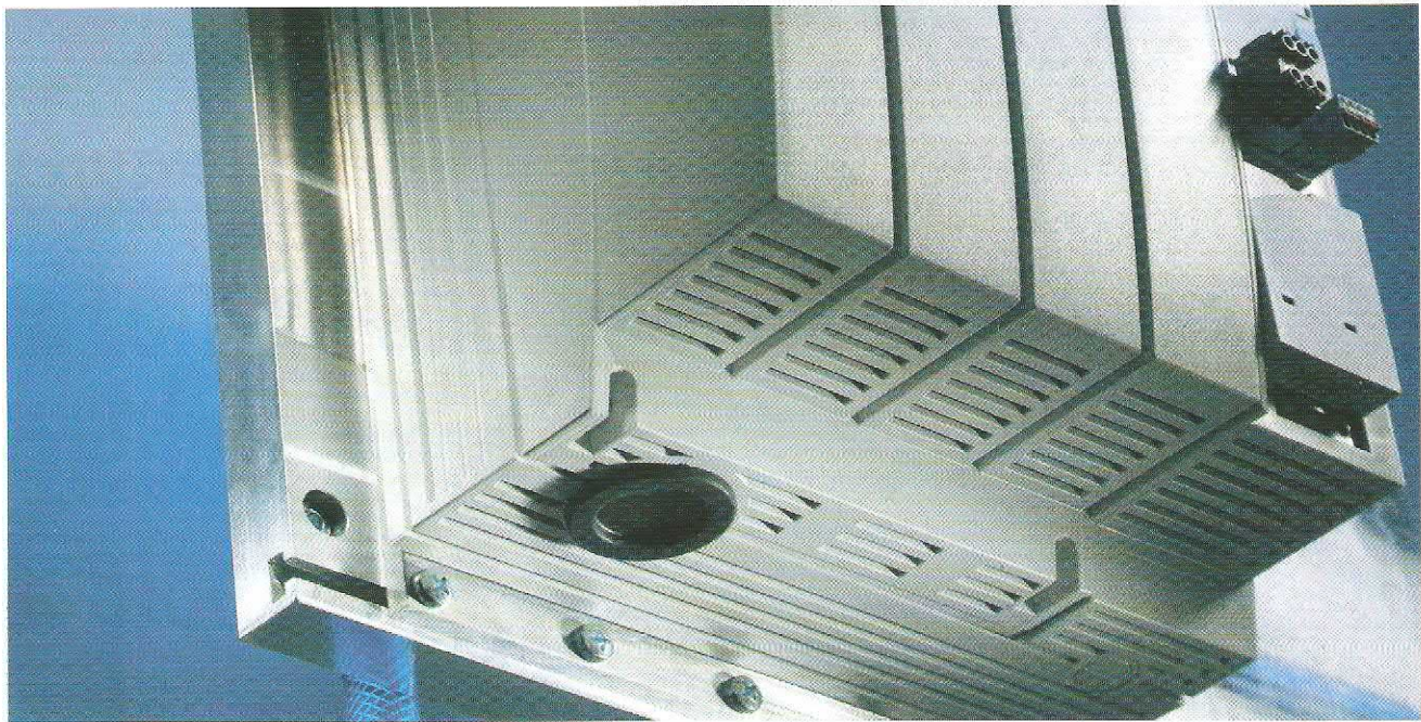
Rittal Direct Cooling Package: refrigeración optimizada de un variador de frecuencia con la Direct Cooling DCP de Rittal, una placa de montaje parcial con paso de líquido que disipa elevadas potencias de pérdida.
