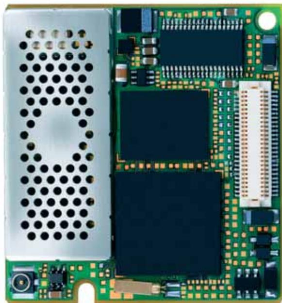
*El M55/56 soporta comunicaciones de voz y transmisión de datos de alta velocidad GPRS Clase 10.*
