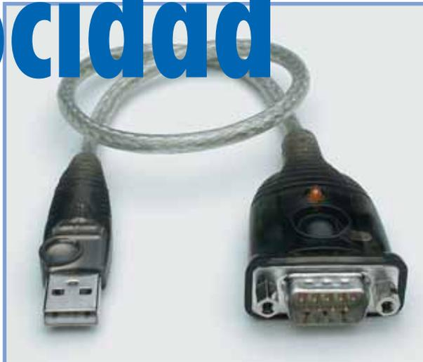
**Figura 1.** Adaptador construido por la compañía Manhattan, de Taiwán. La electrónica se ensambla dentro de un conector sub-D.
