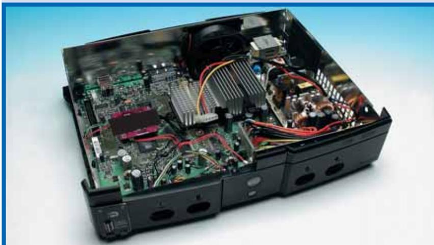
**Figura 2.** El circuito integrado modificado interno, Xecuter 3, está conectado en su lado izquierdo a un conector tipo "header". En la parte frontal del lado izquierdo está la abrazadera que acompaña y que se utiliza para instalar el circuito integrado.
