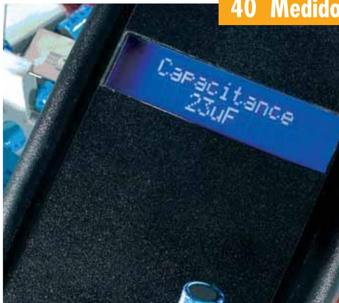
Las dos características más importantes de un condensador son su capacidad y su resistencia interna (ESR). Necesitamos conocer ambos valores para juzgar si un condensador es adecuado para una aplicación en particular. El medidor que se describe aquí combina dos proyectos muy conocidos de Elektor para crear un nuevo instrumento adecuado que puede pertenecer sin mayores problemas a cualquier laboratorio electrónicos bien equipado.
