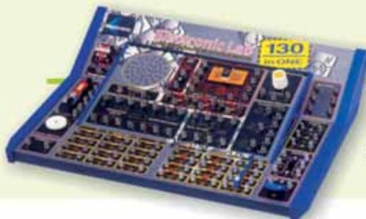
Este completo laboratorio de prácticas permite realizar 130 experimentos de electrónica de nivel medio y empezar a familiarizarse con los montajes y desarrollos TTL, con las puertas NOR, AND, OR y NAND. Se suministra con todo el material necesario.
