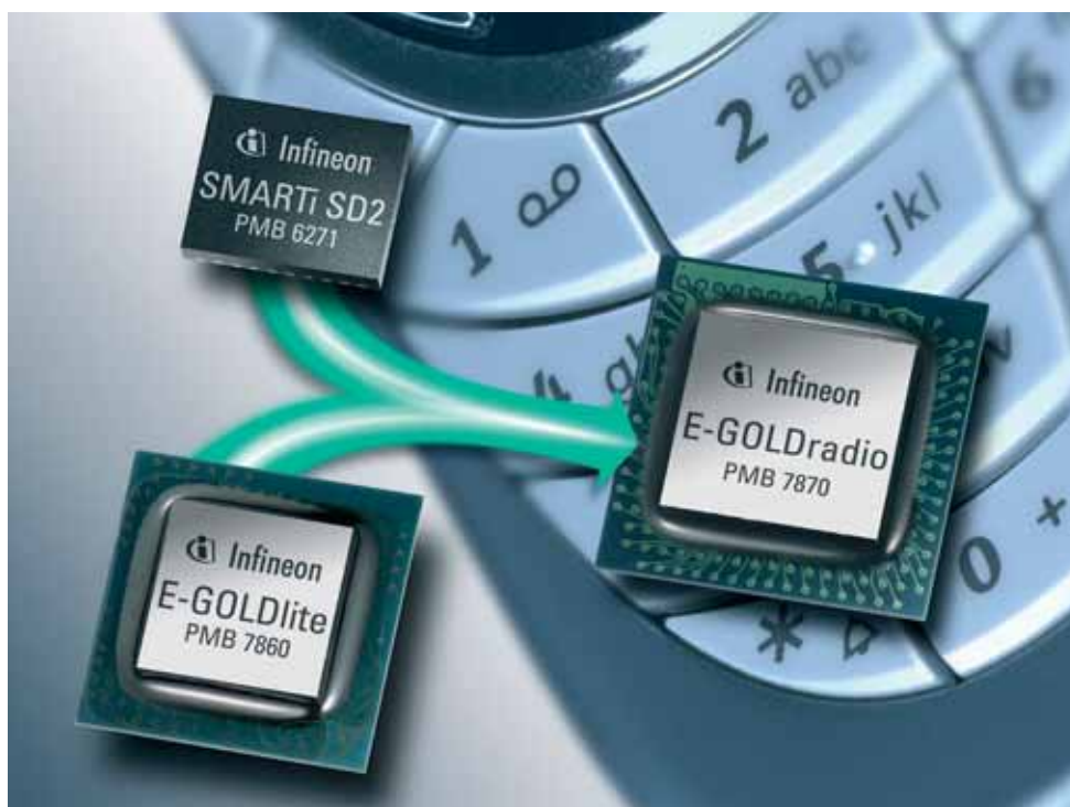
El E-GOLDradio™ combina un transceptor quadband con un procesador de banda base.
