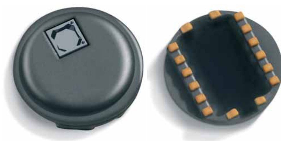
En 6,1 mm de diámetro, el SCP1000, incluye el sensor y un ASIC integrado.
