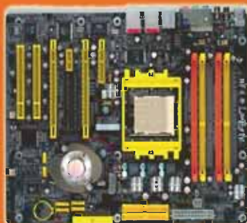
Placa Base DFI Lanparty UT nF4 Ultra-D Con Socket 939 y PCI-Express Ideal para overlockear un Athlon 64
