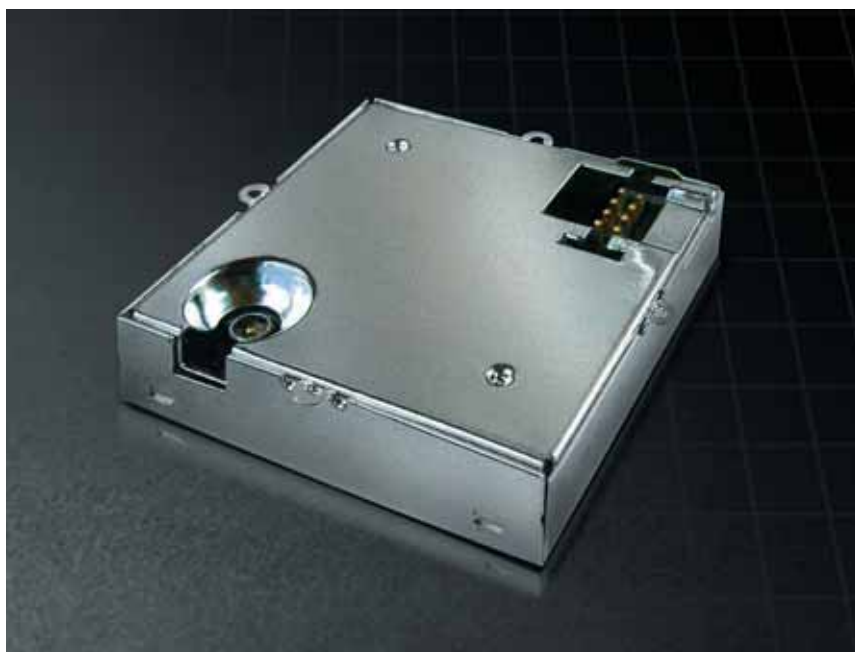
Figura 1. El módulo GPS tiene el tamaño de un sello de correos, aunque su espesor es un poco mayor.
