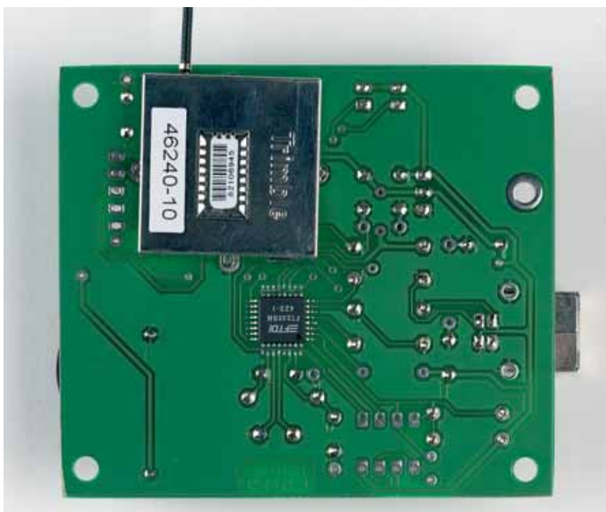
Figura 4. El integrado y el módulo GPS se fijan en la cara inferior de la placa de circuito impreso.
