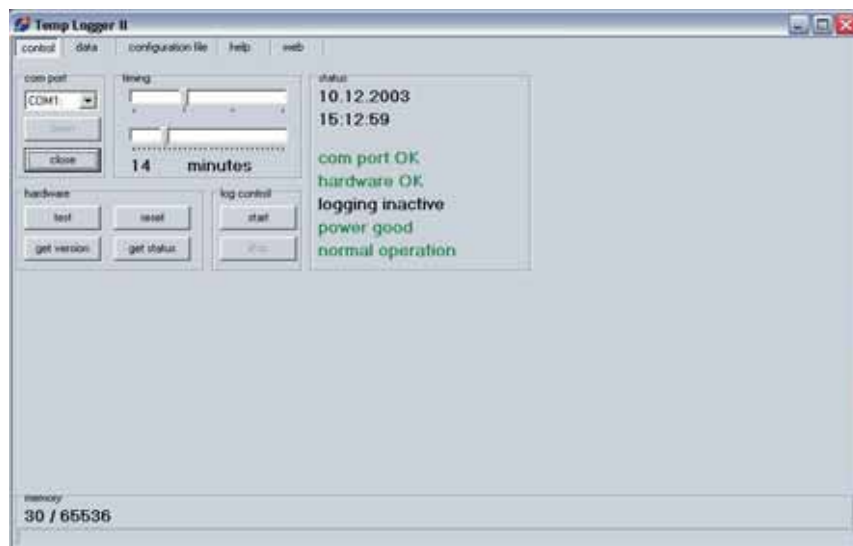
Figura 4. Control del registrador de temperatura mediante un PC.
