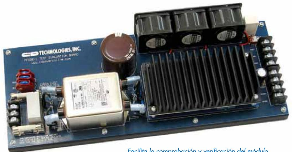
*Facilita la comprobación y verificación del módulo front-end PDA AC/DC PF600-1 48V.*
