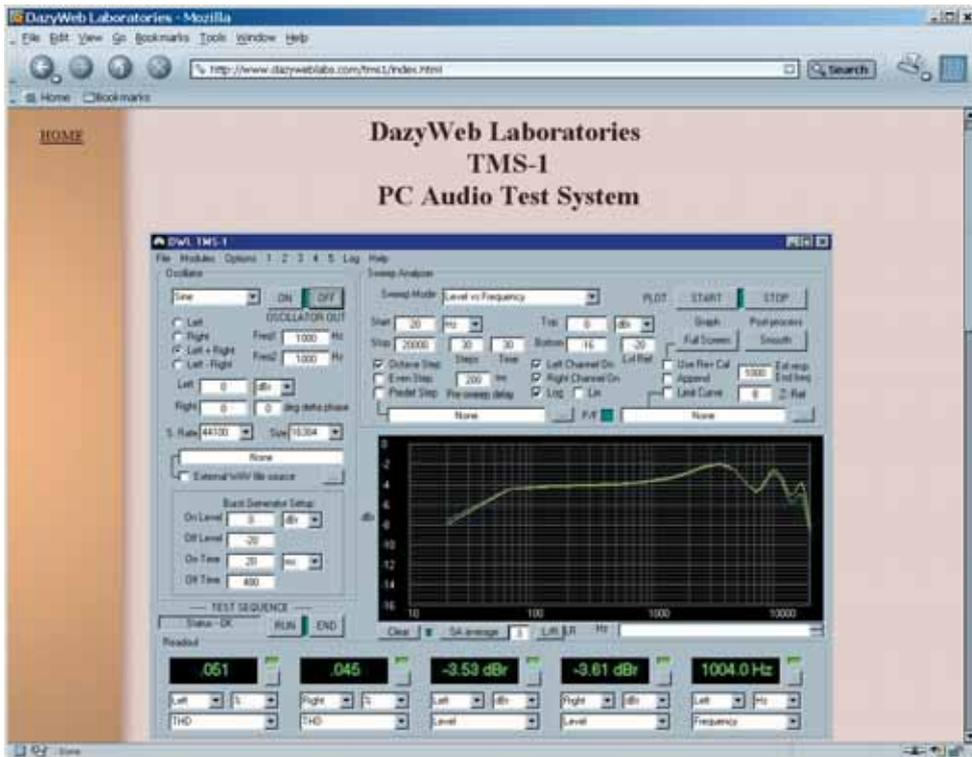
ción de 24 bits y un muestreo de 192 KHz. Un excelente punto de inicio para un sistema de medida basado en un PC.
