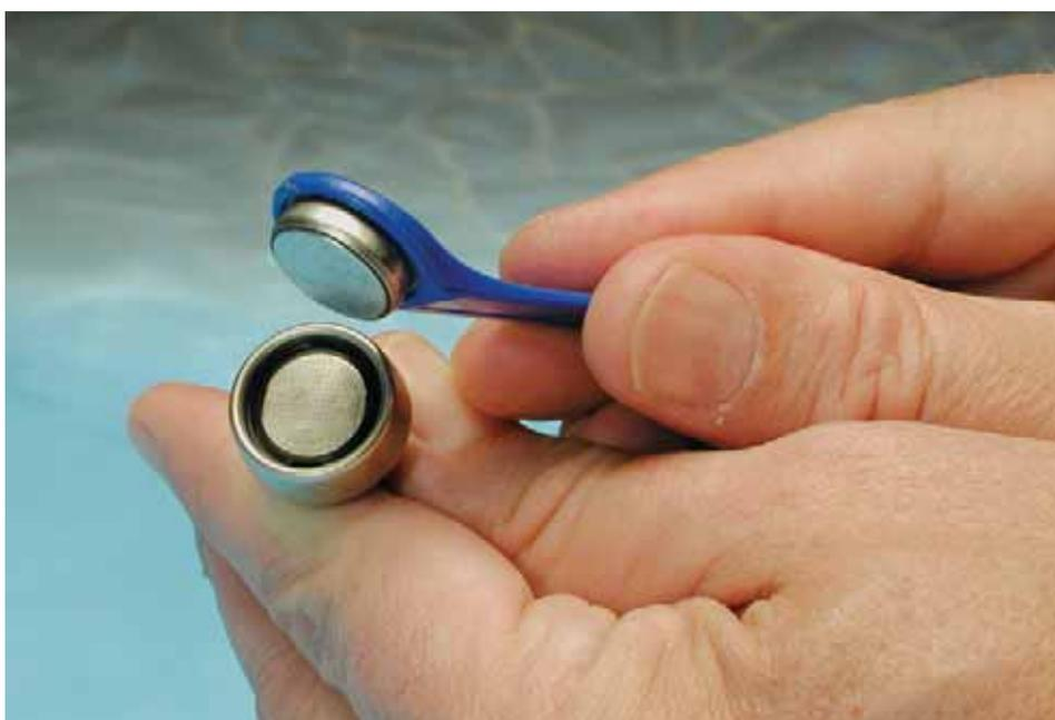
Figura 1. Un iButton DS9092 con la sonda de la lectura asociada.
