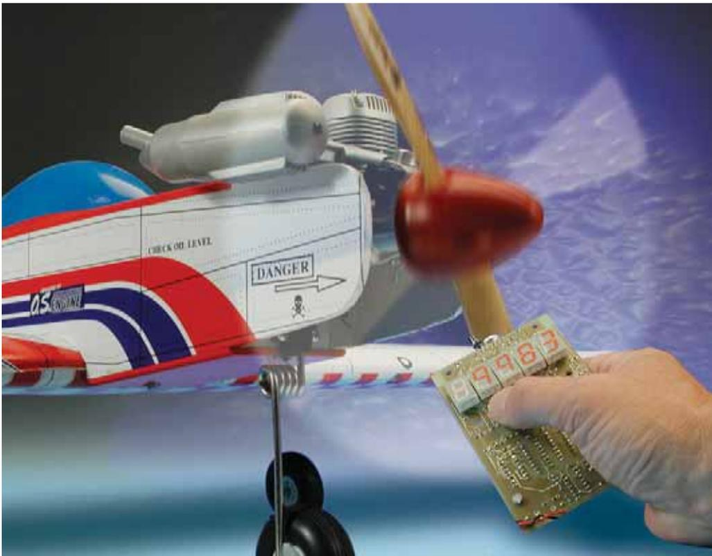
Si queremos obtener el mejor rendimiento de nuestro motor, es esencial que su velocidad pueda medirse con precisión. Con la ayuda de un buen contador de revoluciones, el carburador puede ajustarse correctamente a plena potencia
