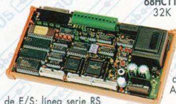
68HC11A1 de 8MHz; 32K RAM; 32K EPROM; 8K RAM + Reloj con batería de Litio; 0,5K E<sup>2</sup>; 8 líneas de conversores A/D; 32 líneas
